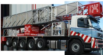
La Pasarela de Inspección consiste en una pasarela articulada de 20 metros de longitud y 1,5 metros de ancho que se recogen en un camión que permite transportarla al lugar de trabajo. Este equipo permite el acceso a la parte inferior de los tableros de las estructuras con un corte de tráfico en la parte superior de un carril.
