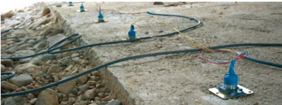
En este método se genera un perfil vertical para tener una visión gráfica en profundidad de la cimentación, con las reflexiones que se producen en las subidas y bajadas de los movimientos de compresión y flexión. En este método, la estructura se golpea en la parte superior o en la inferior (ya sea horizontal o verticalmente) y el movimiento ondulatorio resultante se registra a intervalos regulares hacia el fondo del elemento de la cimentación de la estructura.
