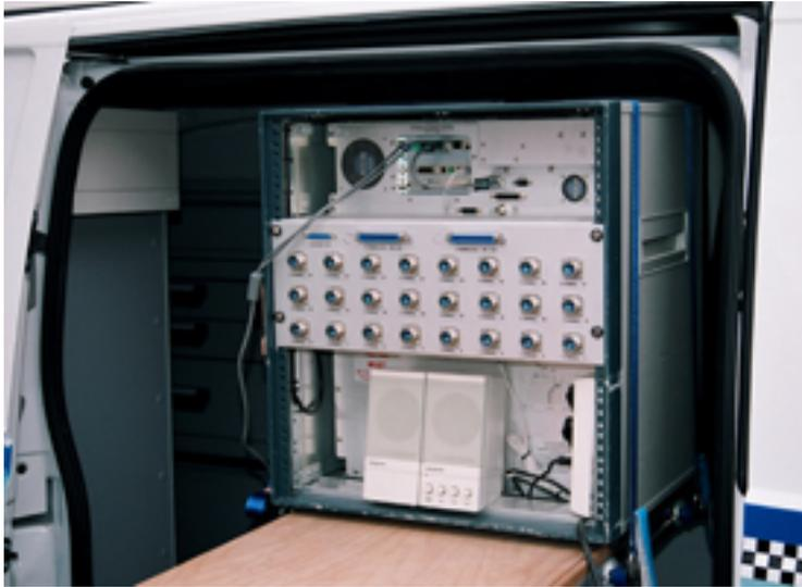
La adquisición de datos resultantes de los ensayos de auscultación de estructuras, tanto de edificación como en obra civil, se realiza a través de un equipo configurado por Euroconsult. Se trata de un equipo muy versátil capaz de adquirir cualquier magnitud física, transformada mediante un transductor en señal eléctrica a través de 32 canales.
